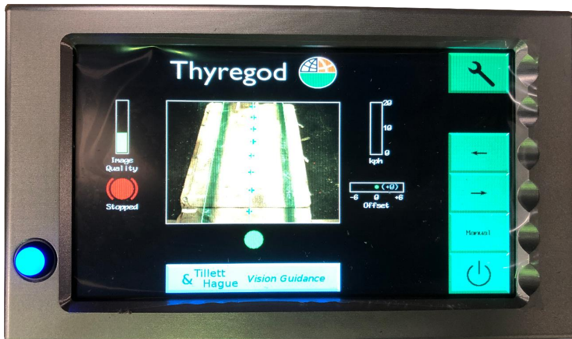
Billedet under drift, men stationær ved maksimal sideforskydning
